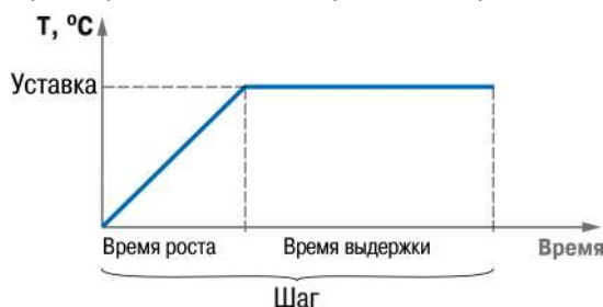
Рисунок 7.5 – Схема шага Программы технолога
