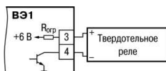
Рисунок 5.14 – Подключение к твердотельному реле
